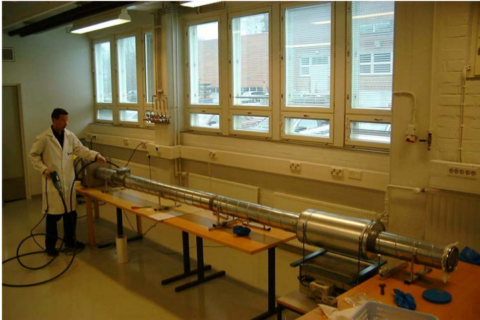
Kuva 3. Puhdistettavuus- eli harjauskokeessa pyörivä harja työnnetään kanavaan ja testattavaan tuotteeseen.
